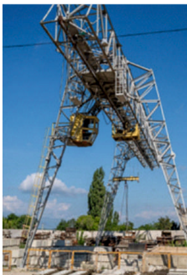
База ООО «Строймаркет» Кран козловой ККС-10г/п-10тн
